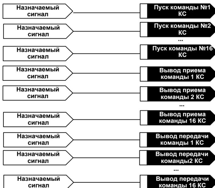
б) схема логической части узла пуска, вывода приема и вывода передачи команды по КС
