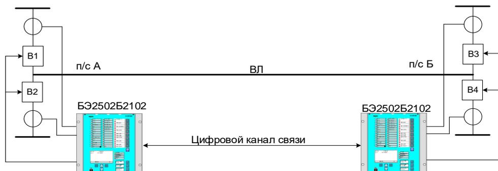
Рисунок 1 – Принцип действия ДЗЛ
